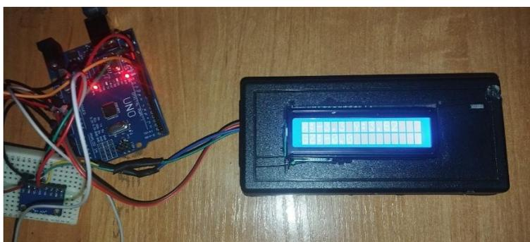
Рисунок 28 – LCD дисплей с данными MPU6050
