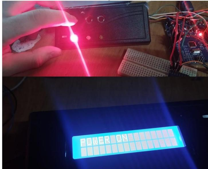
Рисунок 30 – LCD дисплей и кнопка активации системы
