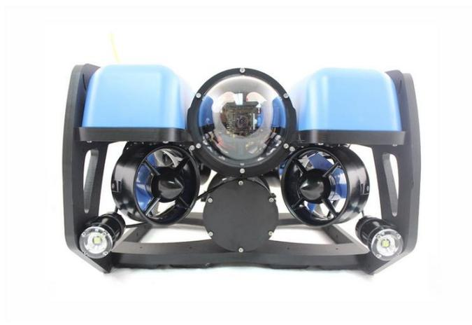
Рисунок 4 – Подводный дрон BlueROV2[4]
