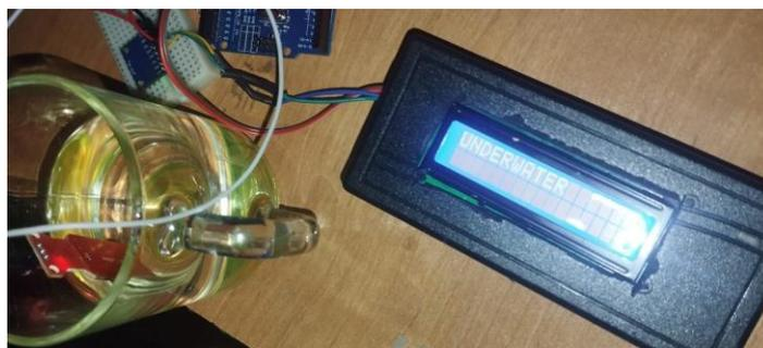
Рисунок 29 – LCD дисплей с данными теста Датчика воды
