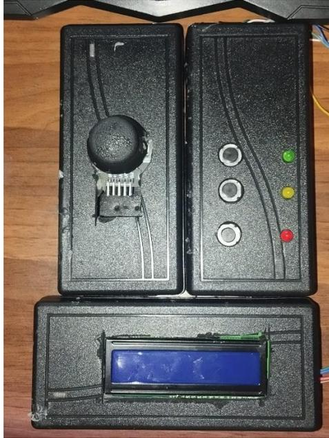
Рисунок 25 – Прототип пульта управления
